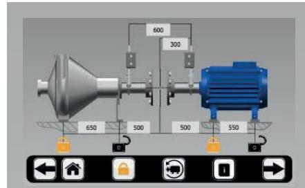
Введите размеры с помощью виртуального калькулятора. Выберите, какие пары опор будут зафиксированы.
