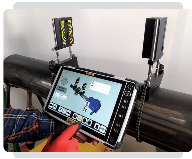
Лазерная центровка валов насосов, компрессоров, вентиляторов, турбин, редукторов является важной операцией, которая требуется во время пусконаладочных работ, после ремонта, а также во время периодического аудита оборудования.
