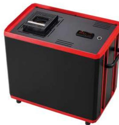
Данная модель представляют собой высокотемпературый микропроцессорный сухоблочный калибратор температуры.
